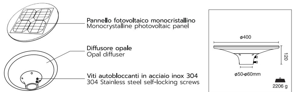
**IT - Dopo il tramonto, ON al 100% per le prime 3 ore, al 70% per le successive 2 ore, infine al 50% fino ad esaurimento. Con il sistema di gestione intelligente, SUNNY XL regolerà la luminosità in base alla capacità dinamica della batteria.**
