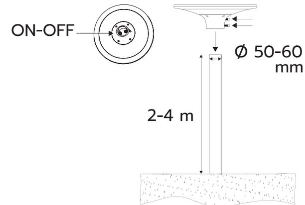
**IT - Accendere il dispositivo con l'apposito tasto Power posto all'interno dell'alloggiamento del palo. Allentare le viti sul corpo lampada, installare su palo (Ø 50-60mm) quindi avvitare saldamente le viti.**
