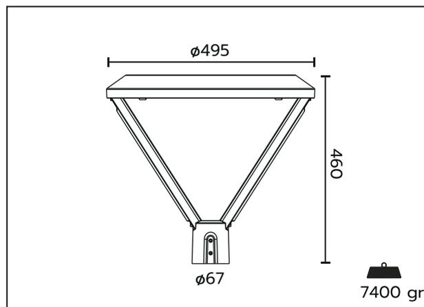
Adatto per pali da  $\varnothing 60\text{mm}$
